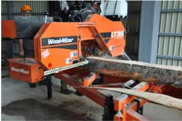
簡易製材機で4mの丸太を挽く
