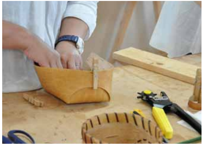
慎重に折り曲げて固定します(折りまげる角は割けないようにパンチで穴を開けて)
